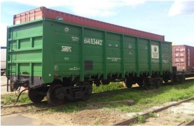
Рис. 1. Розміщення контейнера у напіввагоні
